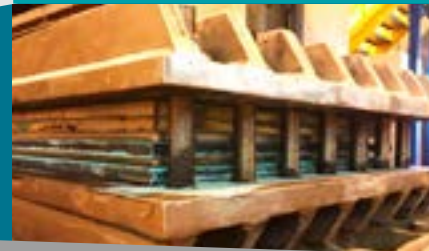
Prototype plaque de refroidissement en Inox 316L outillée avant brasage sous vide
