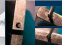
Assemblage d'alliages base nickel - métal d'apport chargé en métaux précieux
