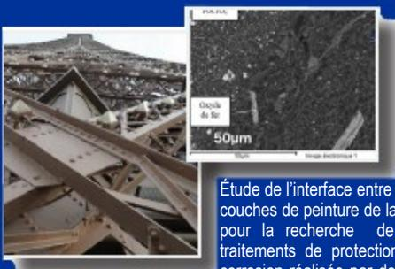
Étude de l'interface entre le fer et les couches de peinture de la Tour Eiffel pour la recherche de nouveaux traitements de protection contre la corrosion réalisée par des étudiants dans le cadre d'un projet ATI.
