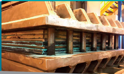
Prototype plaque de refroidissement en Inox 316L outillée avant brasage sous vide
